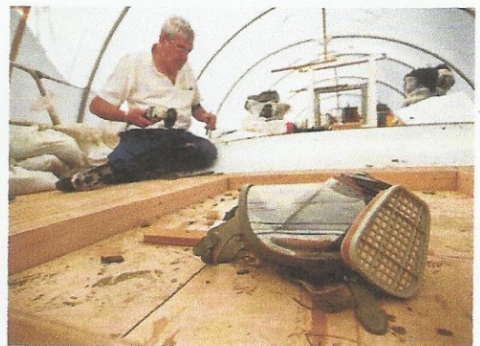
Bescheiden, aber weltbekannt. Die Werft im Hafen von Porto Santo Stefano, wo Teakdecks noch klassisch Stab für Stab verlegt werden – mühsam und langsam, aber stilschön und schön
